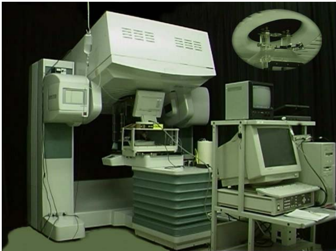
図2 サル脳賦活実験のためのPET実験装置と学習実験装置(手前) サルの固定のためのチェア(円内)
